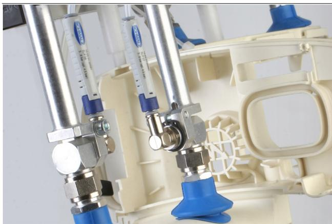
Génération du vide décentralisée par éjecteurs en ligne SLP pour la manipulation de pièces en plastique moulées par injection
